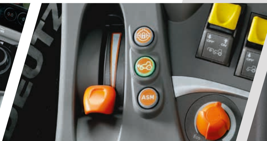
> Tracción a las cuatro ruedas y bloqueo del diferencial con accionamiento electrohidráulico con botón ASM y acelerador de mano independiente.
