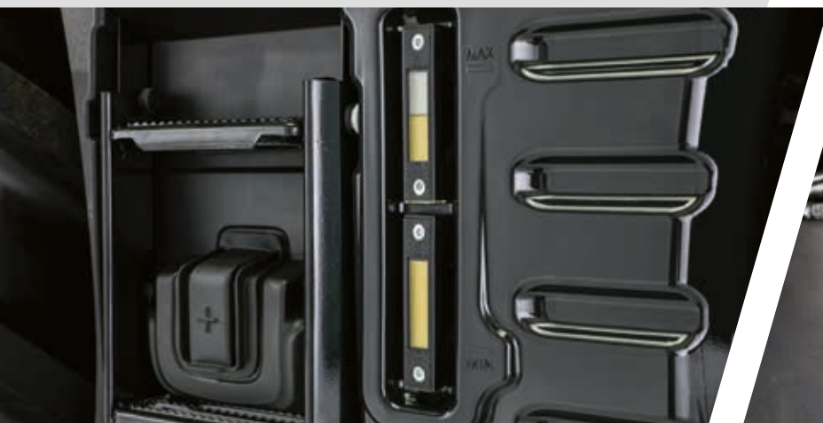
> Puerto de conexión para el arranque de emergencia y mirilla del nivel de aceite.
