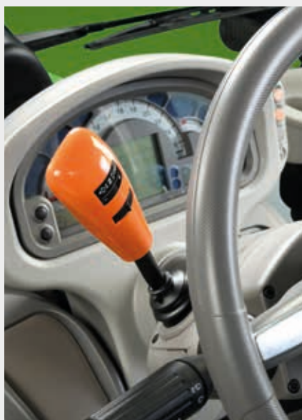
↑ Inversor electrohidráulico con ajuste de la respuesta.
