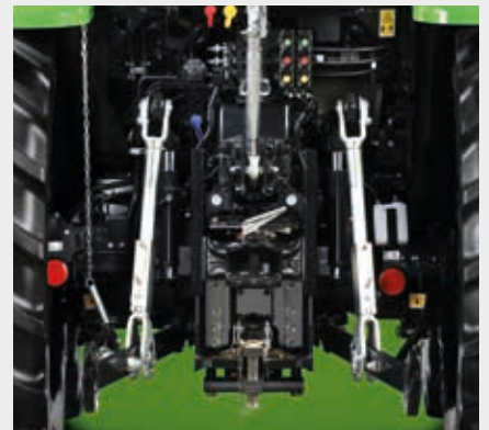
↑ Elevador trasero y sistema hidráulico.
