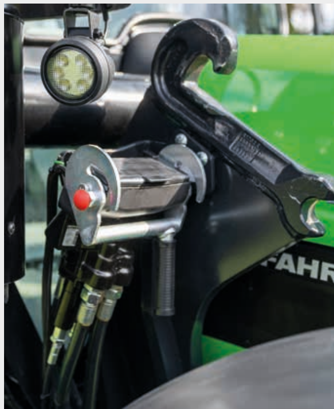
↑ Bastidor fijo de cargador frontal con conexión Hydro-Fix.
