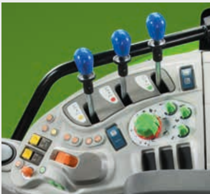
↑ Disposición ergonómica de los controles del elevador trasero y del sistema hidráulico
