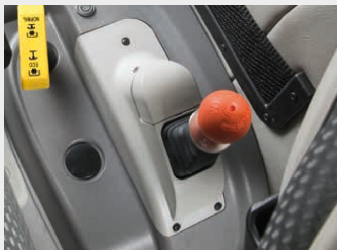
↑ HPB (freno de estacionamiento hidráulico).
