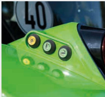
↑ Controles externos para el manejo de la TDF y elevador trasero.
