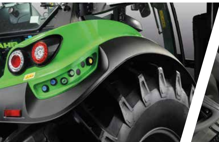
> Mandos externos a ambos lados para el elevador trasero y la TDF y, según el modelo, un distribuidor hidráulico.
