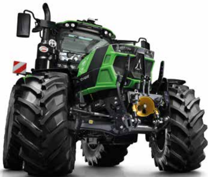
> Eje delantero suspendido con bloqueo del diferencial delantero al 100%.
