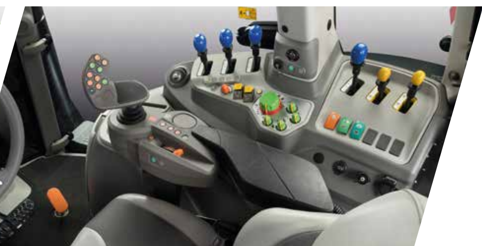
> El equipamiento de la cabina MaxiVision con distribuidores traseros mecánicos en combinación con las transmisiones Powershift (foto grande) y RCshift (foto de arriba) .
