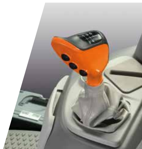
> Palanca ergonómica con botones ComfortClutch, APS y Powershift.
