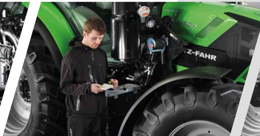
> Se puede acceder a la varilla del aceite del motor sin tener que abrir el capó.
