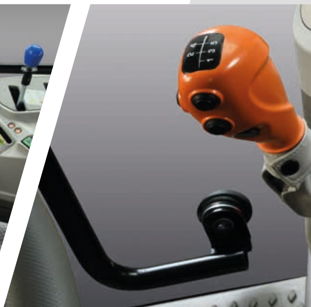
> Palanca de marchas ergonómica con cambios bajo carga y ComfortClutch.
