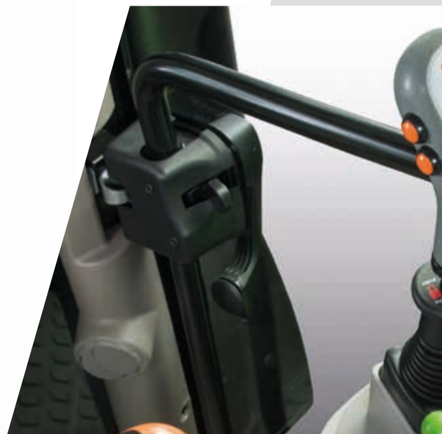
> Joystick con cambios bajo carga para facilitar el movimiento del cargador frontal.
