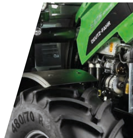
> Motor FARMotion 45 con potencias de 75 a 106 CV con o sin SCR.
