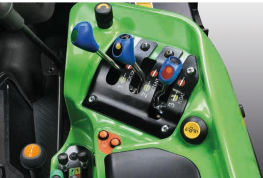
> Fácil accionamiento de la TDF trasera mediante pulsador.
